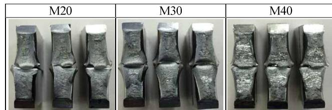
写真5 シャルピー衝撃試験片(ハーフサイズ)の破面外観
