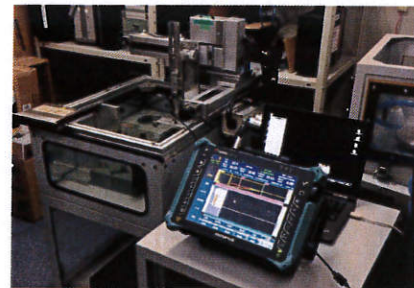
写真 2.1 水浸UTの試験状況
