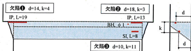
図 2.2 抽出した試験体TP-2のRTとUTの試験結果
