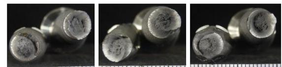
(b) 試験体2 (異径試験体)
