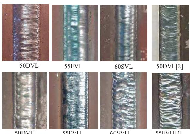
写真1 溶接ビード外観拡大写真（拔粧）
