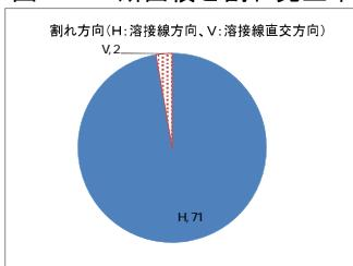
図-2.8 クレータ割れの方向
